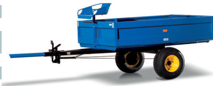
Vyklopená korba vozíka so zloženými 3 bočnicami
